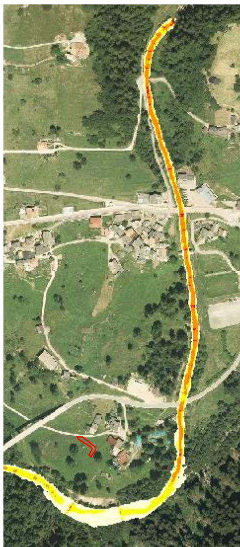
Figura 7.4: Mappa delle velocità dell'acqua (velocità massima) a valle della briglia filtrante su foto aerea nello scenario con portata pari a quella calcolata nel presente lavoro, Q=27 \text{ m}^3/\text{s} .
