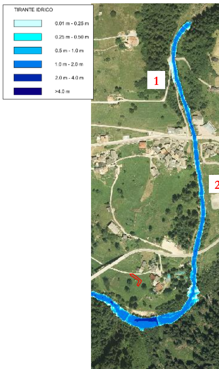
Figura 7.3: Mappa delle aree allagate (tirante massimo) a valle della briglia filtrante su foto aerea nello scenario con portata pari a quella calcolata nel presente lavoro, Q=27 \text{ m}^3/\text{s} .
