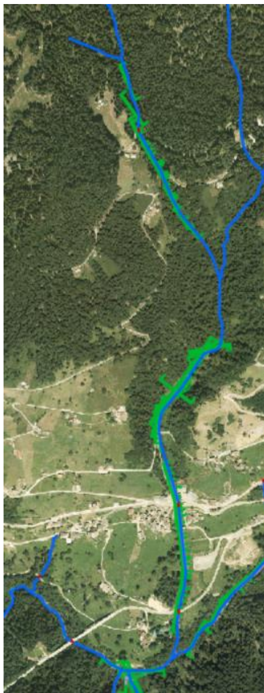
Figura 4.2: Estratto della mappa relativa alle opere in alveo (briglie di consolidamento, briglie di trattenuta, piazze di deposito e arginature) disponibile tramite WEBGis del Serv. Bacini Montani PAT.
