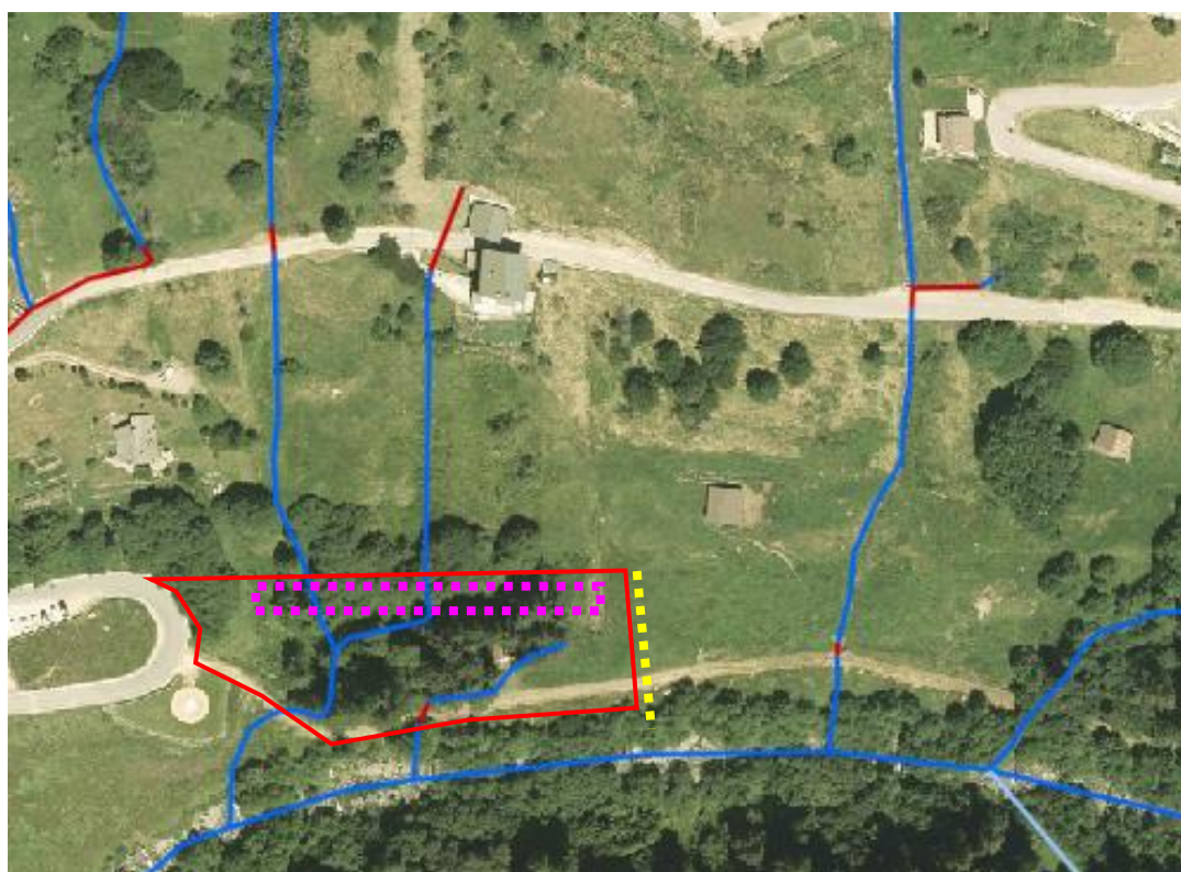
Figura 7.1: Planimetria con individuazione degli interventi di mitigazione idraulica.
