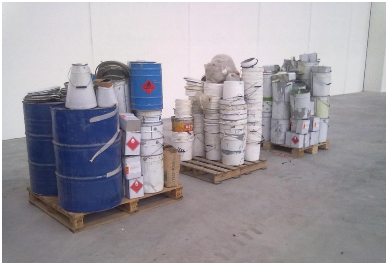
Figura 4.2: Stoccaggio dei rifiuti con separazione dal piano di appoggio
